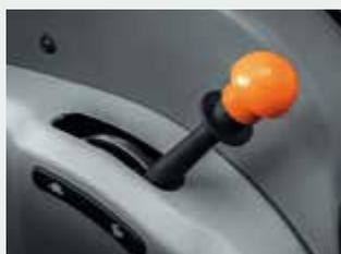
Il joystick meccanico controlla fino ad un massimo di quattro distributori ausiliari ventrali, ideali per azionare con facilità un caricatore frontale dal comodo sedile di guida.
