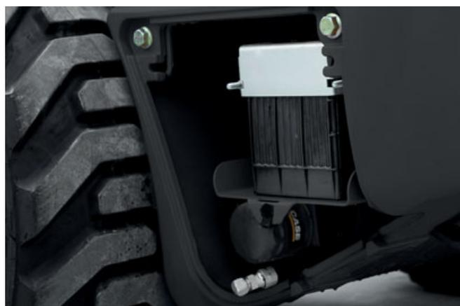
**Accesso intelligente alla batteria e ai tubi flessibili di scarico**
