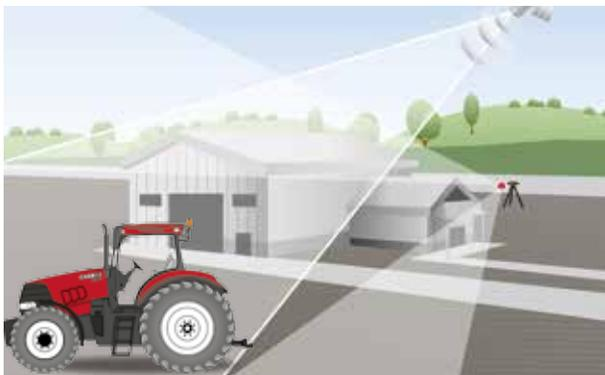
**Il sistema xFill** assicura fino a 20 minuti di connettività di bridging per il mantenimento, in caso di perdita, del segnale RTK.
