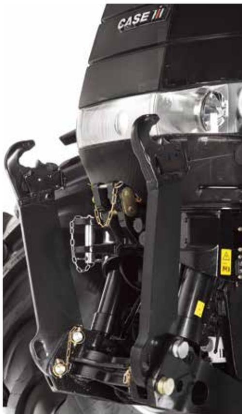
Sollevatore anteriore completamente integrato con capacità di sollevamento sino a 3.785 kg.
