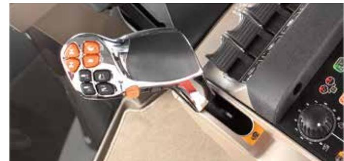
Con il Multicontroller™ è possibile cambiare marcia senza utilizzare la frizione.
