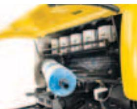
Portarotoli integrato per facilitare la sostituzione delle bobine di rete da terra.
