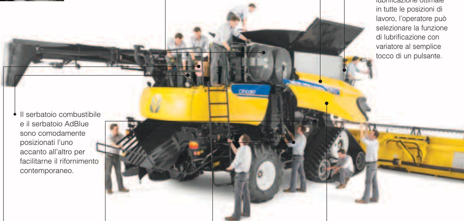
Il serbatoio combustibile e il serbatoio AdBlue sono comodamente posizionati l'uno accanto all'altro per facilitarne il rifornimento contemporaneo.
