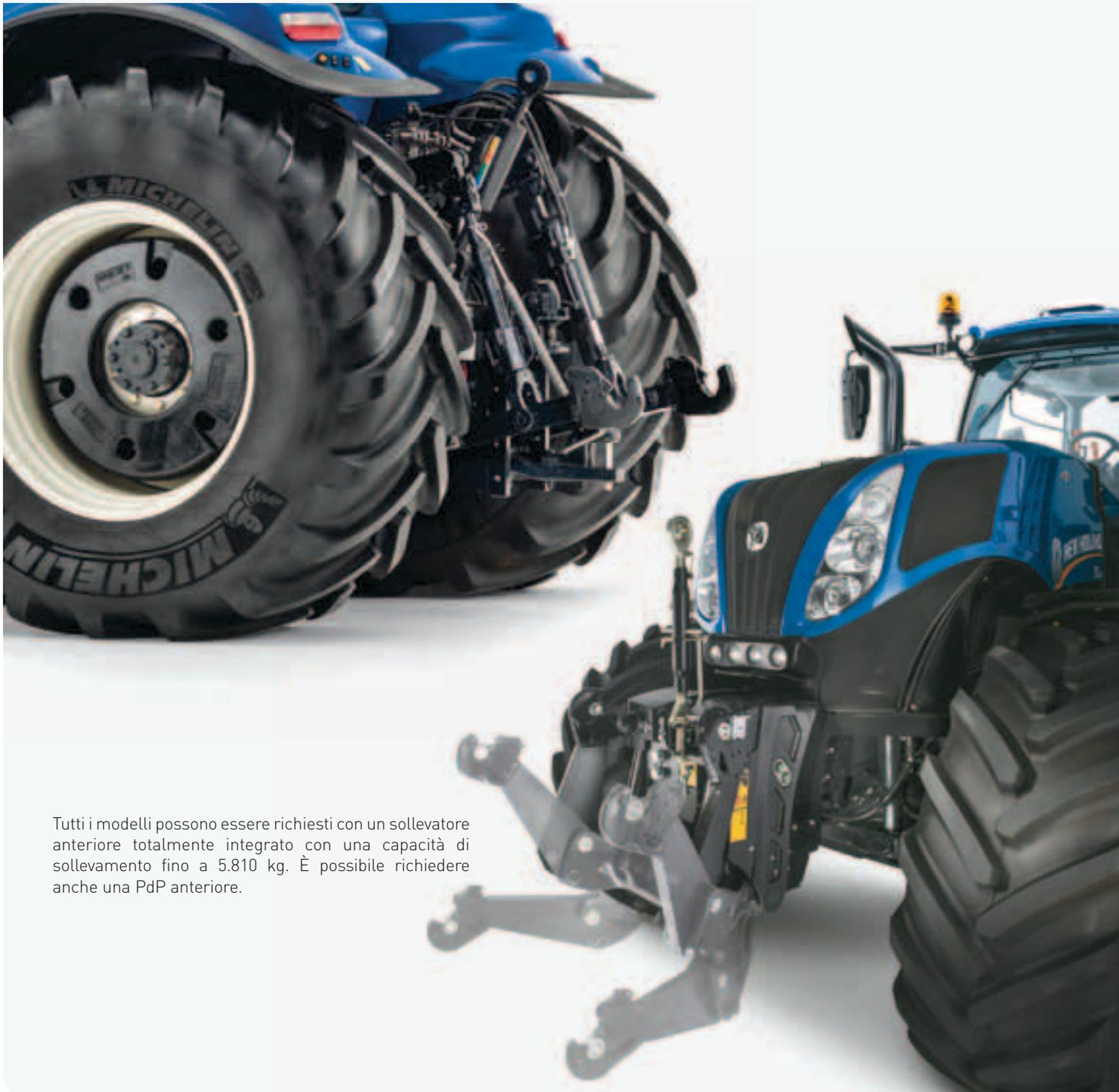
Tutti i modelli possono essere richiesti con un sollevatore anteriore totalmente integrato con una capacità di sollevamento fino a 5.810 kg. È possibile richiedere anche una PdP anteriore.
